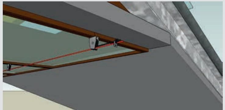
10. Fixez le câble à tirer et reliez la cordelette des lamelles au câble à tirer à l'aide de pinces-câbles en acier.
