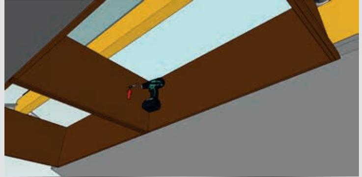
2. Insérez du mastic entre les bacs et reliez ensuite les bacs les uns aux autres à l'aide de vis de 30 mm.
