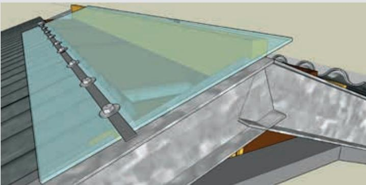
5. Installez la plaque polycarbonate 10 mm des deux côtés. Placez la bande aluminium au-dessus de la panne et de la mousse. Prépercez les trous et vissez les boulons de tôle ondulée jusque dans la panne.
