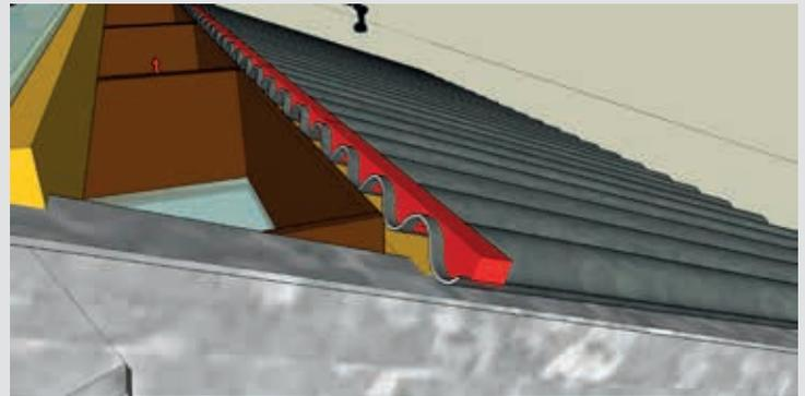
4. Insérez la mousse d'isolation à l'endroit prévu à cet effet. C'est à dire, au-dessus de la panne!
