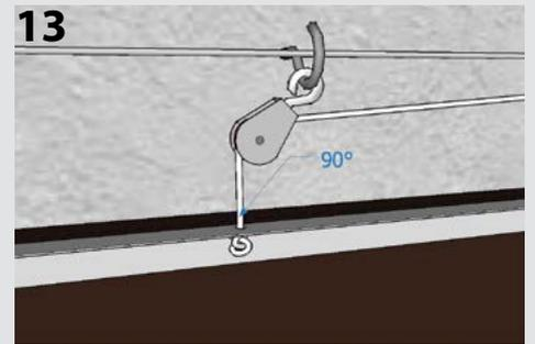
Stellen Sie die Schraubhaken und befestigen Sie die Eckrolle an die Schütze. Sehr wichtig: Schnur vertikal!
