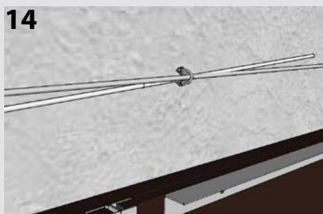
Fixe le corde au câble en inox avec un serre-câble en acier
