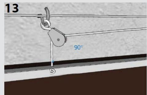
Place le crochet à vis et fixe le poulie au panneau: Important: corde doit être vertical!
