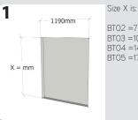
BT02 =720 mm BT03 =1075 mm BT04 =1430 mm BT05 =1785 mm
