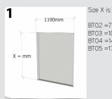
BT02 =720 mm BT03 =1075 mm BT04 =1430 mm BT05 =1785 mm
