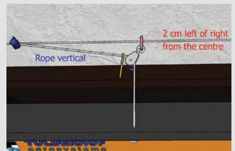
Conectar la cuerda por medio de la polea RVS sujetar en el alambre de tracción con la abrazadera de cable
