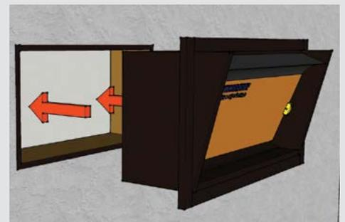
Ventil in die Aussparungen einsetzen
