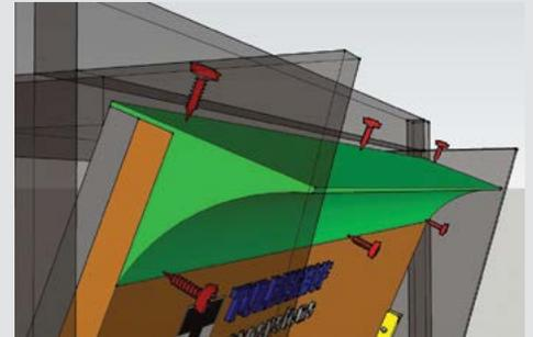
Schrauben Sie das Profil: 6x Schrauben
